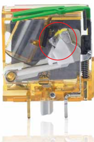
A fine vita, apertura del disconnettore termico e innesco di un arco elettrico in corrente continua
